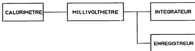
Fig. 2. Tableau synoptique de mesure à l'aide du calorimètre CRMT basculant.
